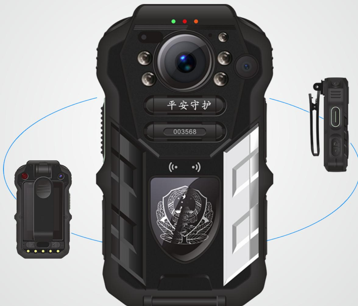
全面升级的F2, 拥有三摄像头, 支持微距摄录、自拍签到、NFC和指纹识别, 兼具强大的勤务、执法、联动能力, 真正对执勤执法人员做到监督、考核, 管控到位。
